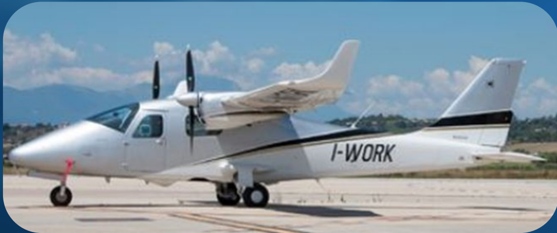
Aerobomile per rilievo topografico - Velocità media 260 km/h, autonomia 1300 km, in volo a 700m di altezza
